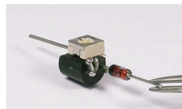
Bild1: der Minibaustein 7202 LED Konstantlicht
